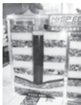
写真① 柱状改良・鋼管杭
